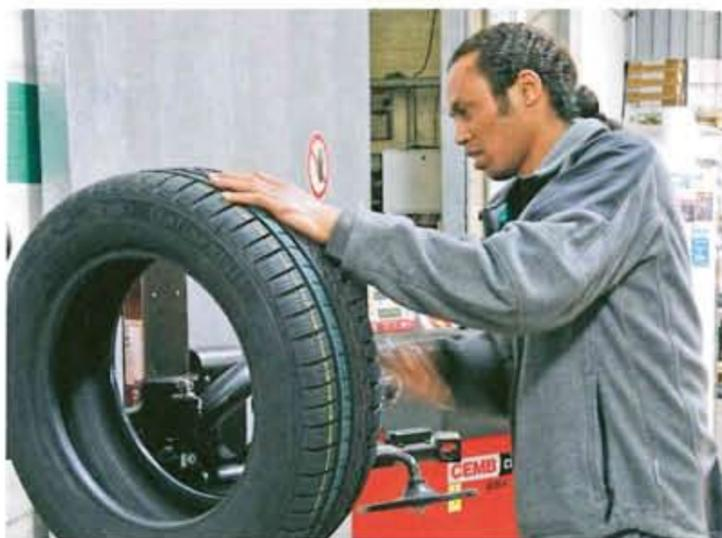
Ein Neureifen wird für die Montage vorbereitet.
